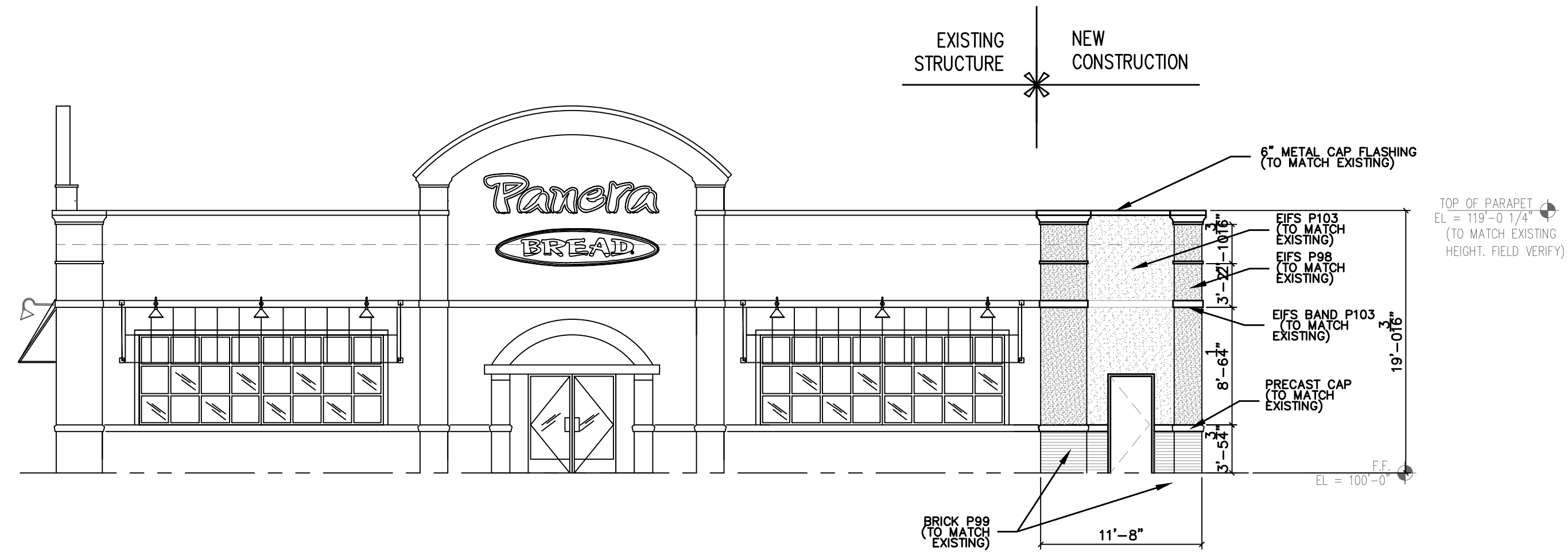
11 WEST ELEVATION SCALE: 1/8"=1'-0"
